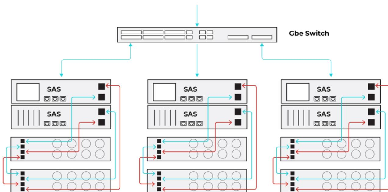
Рис. 496. Соединение СХД для работы в многоконтроллерном режиме
