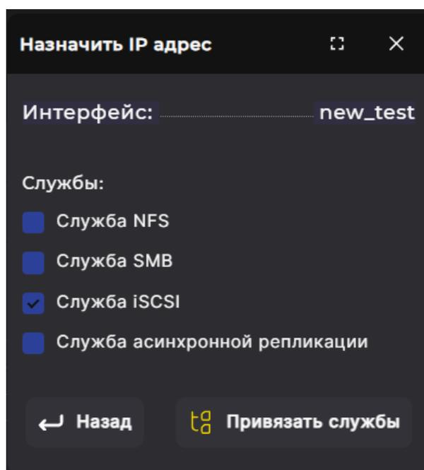
Рис. 220. Окно привязки служб к интерфейсу
