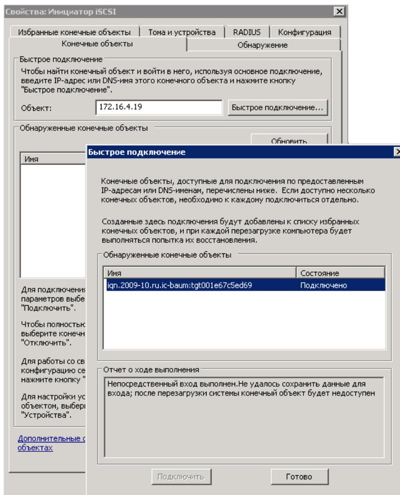
Рис. 443. Настройка доступа по протоколу iSCSI
