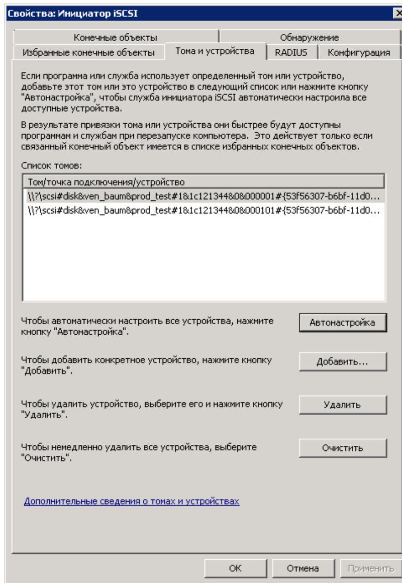
Рис. 445. Настройка доступа по протоколу iSCSI (продолжение)
