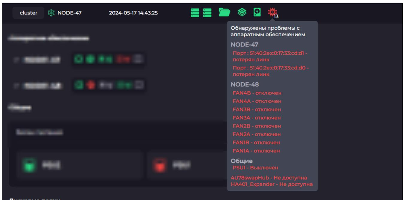
Рис. 474. Уведомления о проблемах с аппаратным обеспечением
