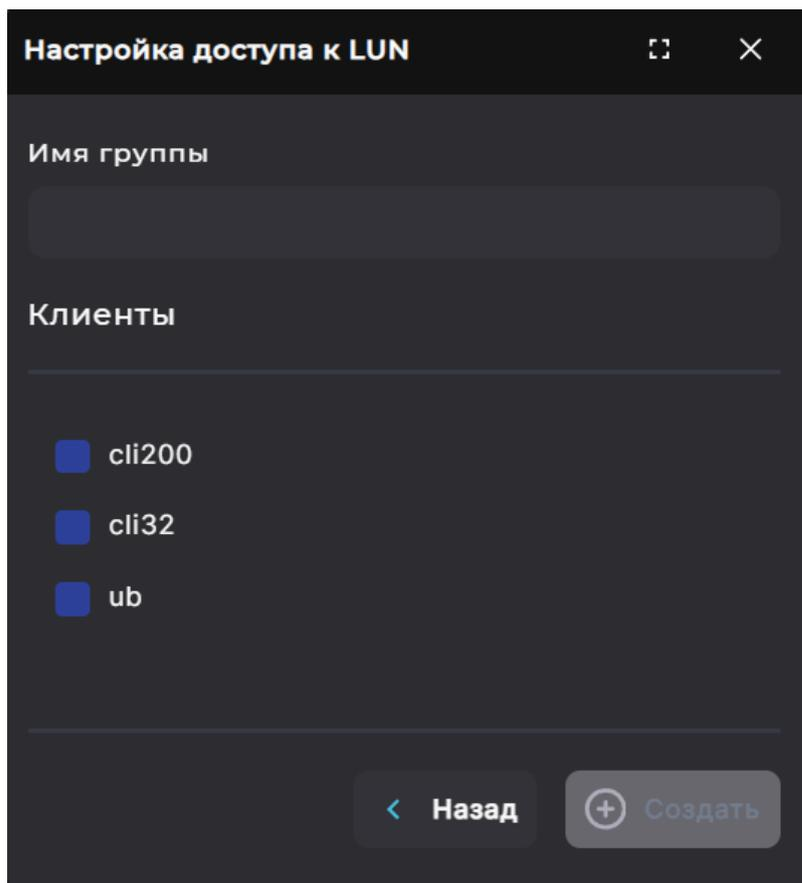
Рис. 206. Настройка доступа к FC LUN. Создание группы доступа
