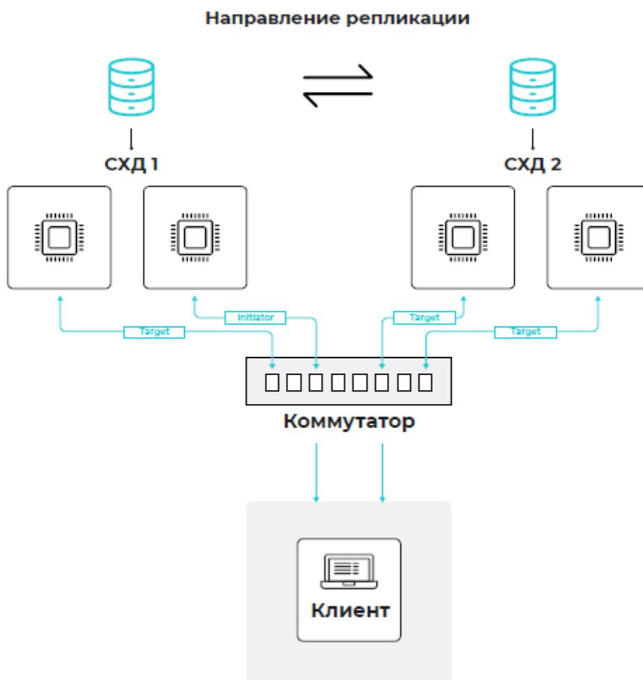
**Рис. 392. Схема коммутации портов СХД для настройки синхронной репликации**
