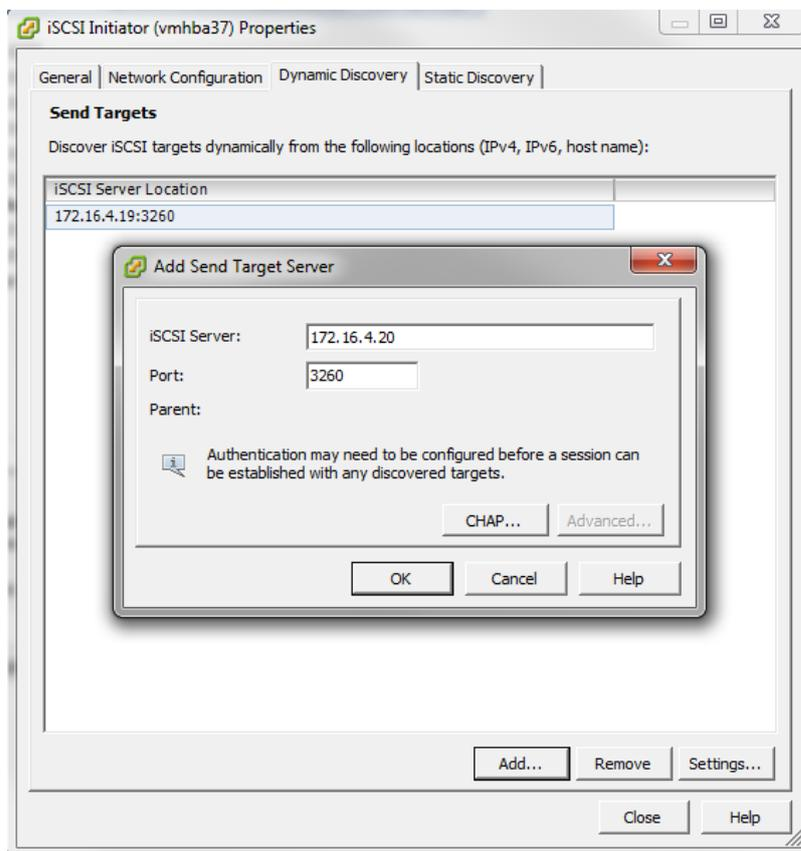
Рис. 452. Подключение к iSCSI Targets в VMware ESXi
