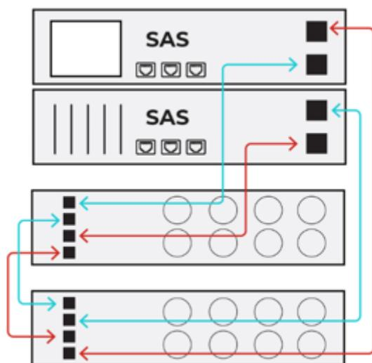
Рис. 493. Подключение полок по двум путям
